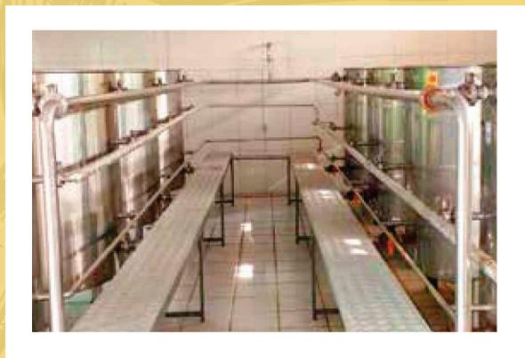
O produto utilizado como cachaça, é referente a parte central da destilação, chamada de “coração”. É separada a parte do início e final da destilação, que será utilizada para produção de álcool combustível. A cachaça é então transportada por tubulação para tanques de aço inoxidável, onde será descansada, e para barris e tonéis de madeira, onde será envelhecida. Após períodos de descanso e envelhecimento será então padronizada e envasada para comercialização.
